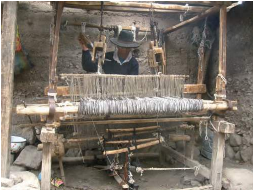
Telar a pedal donde elaboran tejidos como mantas, ponchos y frazadas. Tanta
